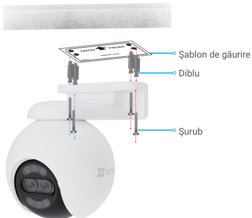
Fig. 1 Instalare pe tavan
